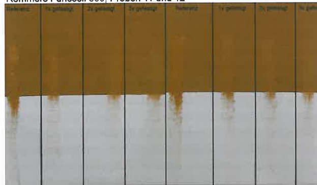
Abb. 27 Funcosil 300: Abriebtest nach Bewitterung
