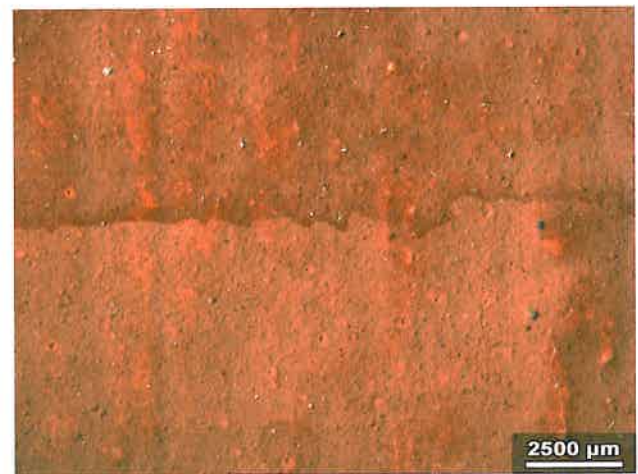
Abb. 12 Paraloid B72: Verstärkte Randbildung und Verdunkelung gegenüber Referenz bei 1 Anstrich, 10%.
