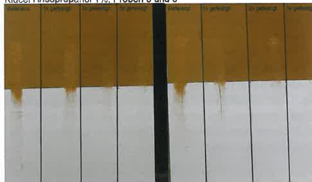
Abb. 24 Klucei H: Abriebtest nach Bewitterung
