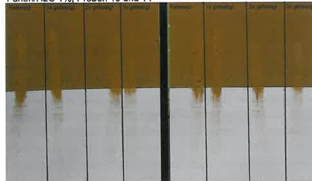
Abb. 28 Funori: Abriebtest nach Bewitterung
