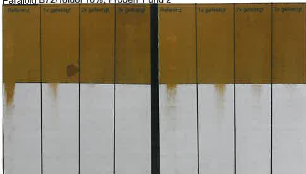
Abb. 22 Paraloid B72: Abriebtest nach Bewitterung im Vergleich zur ungefestigten Referenz (Jeweils linke Spalte der 2 Replikate mit Referenz, 1x, 2x, 3x gefestigt)
