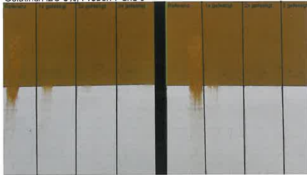
Abb. 25 Tech. Gelatine: Abriebtest nach Bewitterung
