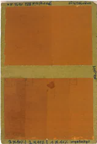
Abb. 5 Paraloid B72, vor Bewitterung. Auf der unteren Probenhälfte ist die Rand- und Fleckenbildung zu beachten, welche mit zunehmender Konzentration intensiviert (von rechts nach links).
