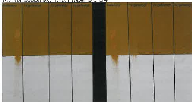
Abb. 23 Acronal 500D: Abriebtest nach Bewitterung
