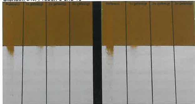
Abb. 26 Störleim: Abriebtest nach Bewitterung
