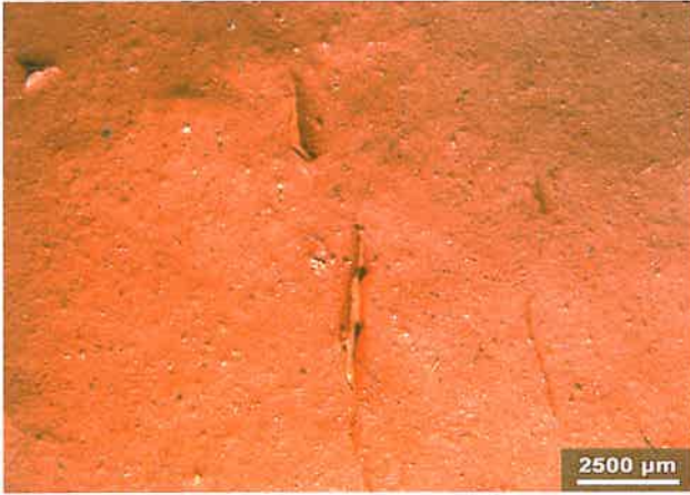
Abb. 19 Technische Gelatine: Spannungsrisse bei überhöhten Konzentrationen (3 Anstriche) nach der künstlichen Bewitterung.
