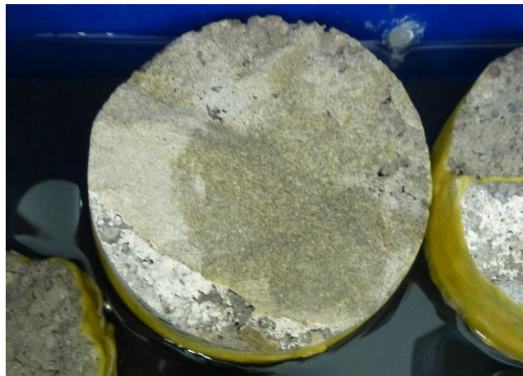
Abbildung 25: Prüfkörper L3 im Anfangsstadium der Durchfeuchtung.
