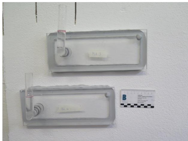
Abbildung 14: Detailaufnahme der Messung Mit 3 und Mit 4 an der Testfassade mit Farbanstrich.
