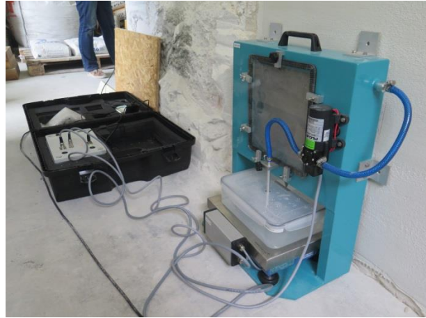
Abbildung 15: Das installierte Wasseraufnahmemessgerät an der Testfassade mit Farbanstrich.
