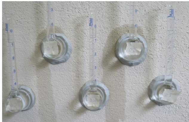
Abbildung 8: Detailaufnahme der zwei undichten Prüfrohren O1 und O2.
