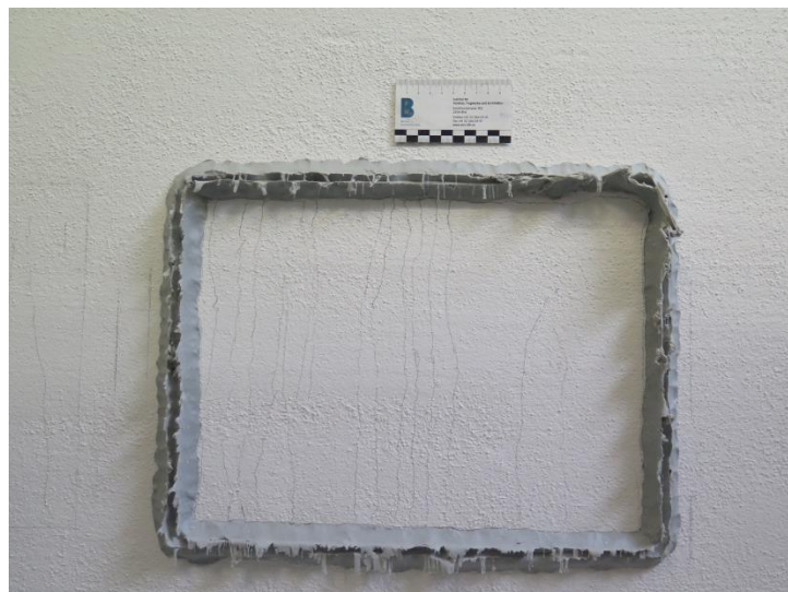
Abbildung 17: Markierte Flächen, die während der Messung nicht benetzt wurden.
