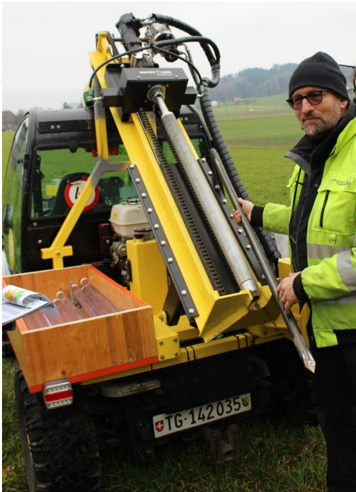
Abbildung 1. Bohrfahrzeug der Firma bodenproben.ch. Mit dem Bohrturm lässt sich sowohl die Bohrhülse für den 36-mm-Bohrkern bedienen (auf dem Bild montiert), wie auch den 18-mm-Stechbohrer (in der Hand des Geschäftsführers von bodenproben.ch). (Foto: KOBO).
