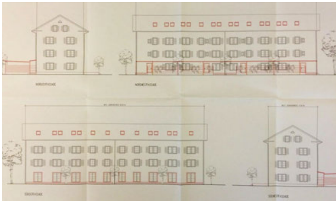
Abbildung 143 , Fassadenpläne gem. Baugesuch Projekt Riverside. Kanalseitig zeigen sich im Erdgeschoss breitere, bis zum Boden geschnittene Fenster, Seite Kanalstrasse wurde ein Carport mit Glasdach dem Kosthaus vorangestellt, eine Reihe Dachfenster belichten das Dachgeschoss. (Baugesucharchiv Windisch, Baug.Nr. 01/098)
