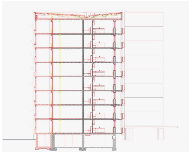
Abbildung 42: Teilgrundriss und Schnitt des erweiterten Zeilenbaus. Die Erweiterung der Wohnungen ist rot gekennzeichnet. Rolf Mühlethaler Architekten
