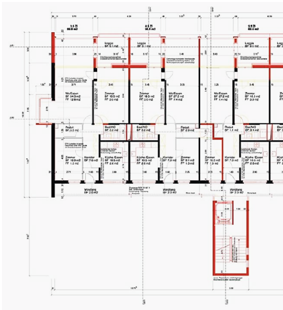
Abbildung 42: Teilgrundriss und Schnitt des erweiterten Zeilenbaus. Die Erweiterung der Wohnungen ist rot gekennzeichnet. Rolf Mühlethaler Architekten
