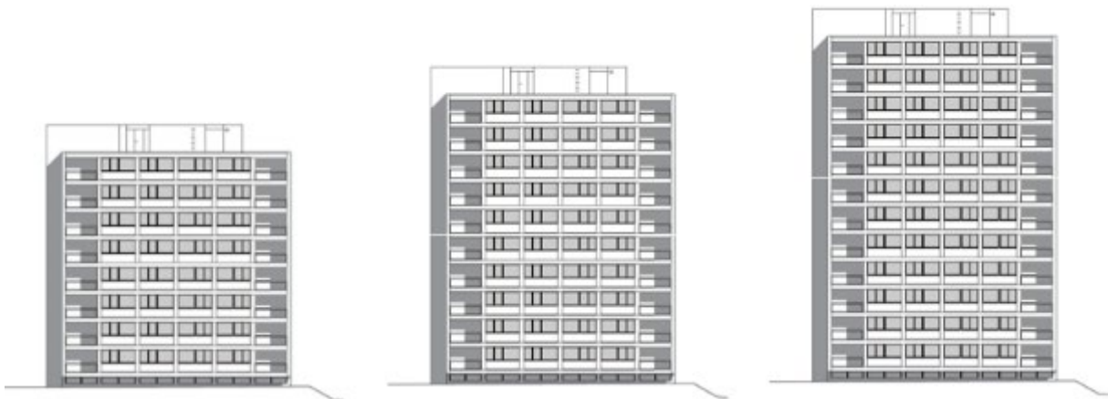
Abbildung 85: Aufstockung durch Verschmelzung mit dem bestehenden Gebäude. Ganz links ist ein Hochhaus der Cité du Levant in seiner Originalform zu sehen. Rechts davon mit zwei bzw. vier weiteren Geschossen. Dadurch erhält das eher gedrungene Originalhochhaus ein schlankeres Aussehen. Durch die Aufstockung um eine Etage kann die Einwohnerzahl der Cité du Levant um 10 bis 15 Personen erhöht werden.
