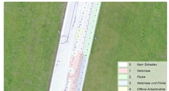
Abbildung 1: Mit Drohne erhobenes Orthofoto der Teststrecke mit Zustandsauswertung der Oberflächenschäden
