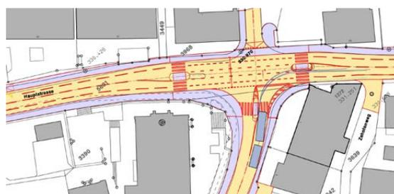
Abbildung 2: Knoten ohne Lichtsignalanlage (Bestvariante)
