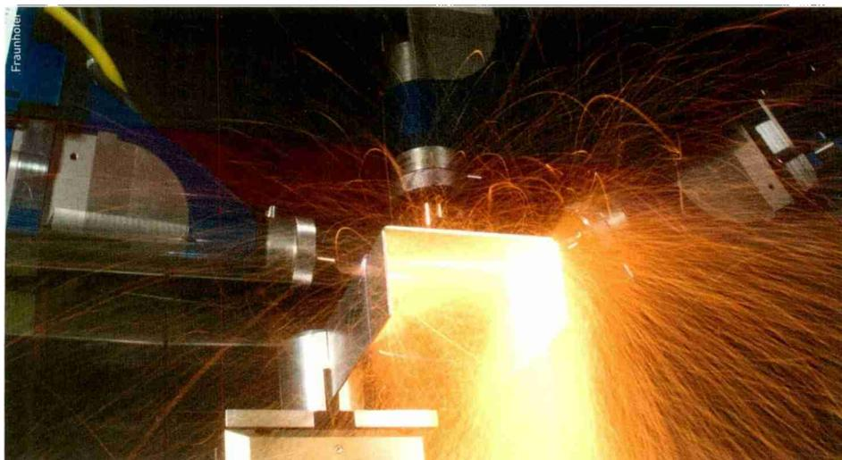
Laser-Kombikopf zum Schneiden und Schweissen sowie für die additive Fertigung durch Laserauftragschweissen.
