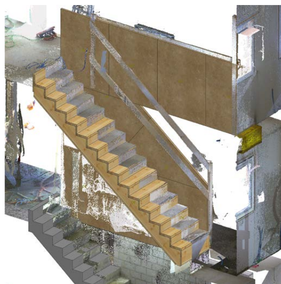
Arbeiten mit der Punktwolke im Cadwork (Quelle: S. Müller Holzbau AG)
