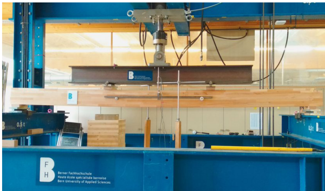
Au banc d'essai: les lamellés-collés de tasseaux de hêtre permettent d'obtenir des structures porteuses dont la résistance à la flexion dépasse 60 mégapascals (MPa). LDD
