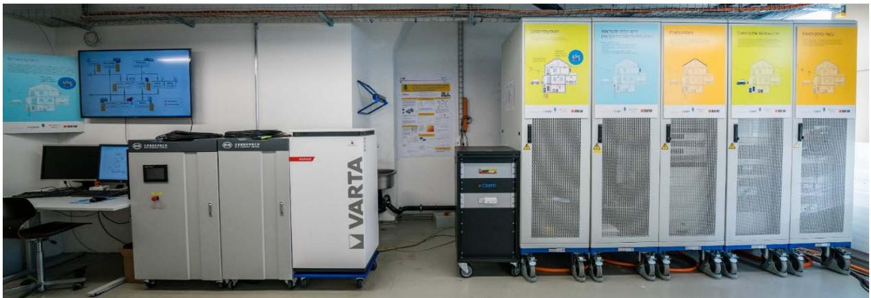
Abbildung 1 : Test Bench mit Arbeitsplatz, Batterien und Racks für stromführende Geräte, die PV, Grid und Lasten emulieren sowie Steuerungs- und Messfunktionen enthalten.
