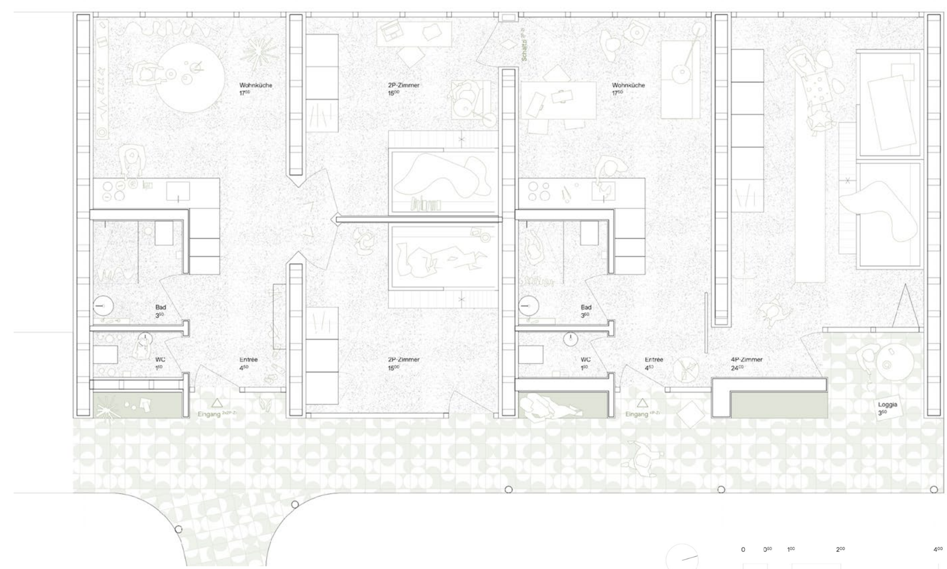
Grafik 3: Schaltbare 2P-Zimmer ermöglichen Flexibilität in der Konstellation; Variation der Aussenräume durch die vor- und zurückspringende Fassade.
