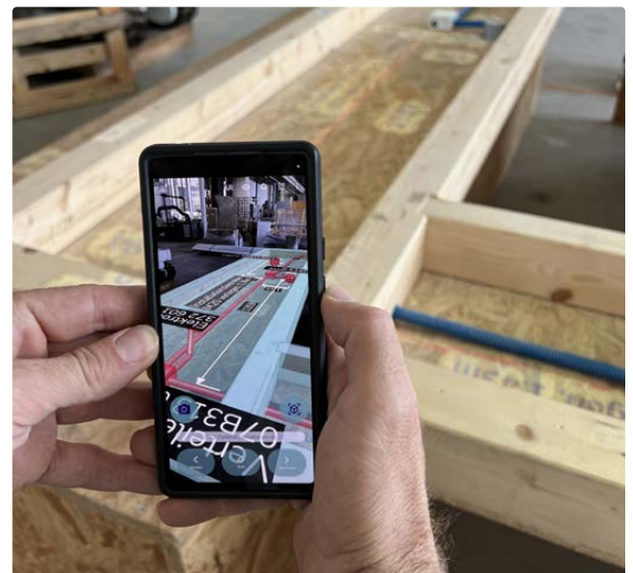
Anwendung des Augmented Reality-Systems in der Elementproduktion (Quelle: eigene Darstellung)
