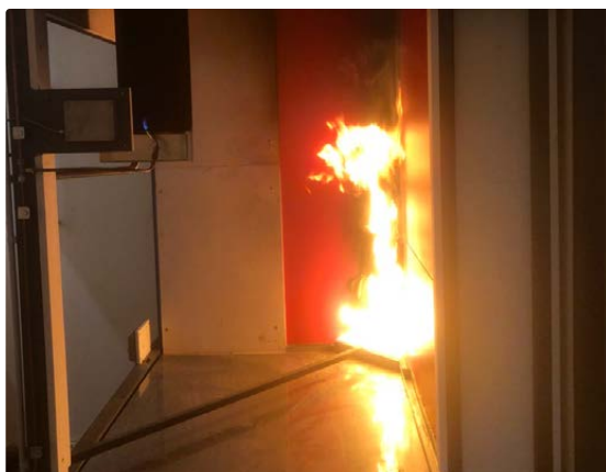
SBI-Prüfstand zur Klassifizierung des Brandverhaltens von Bauprodukten
