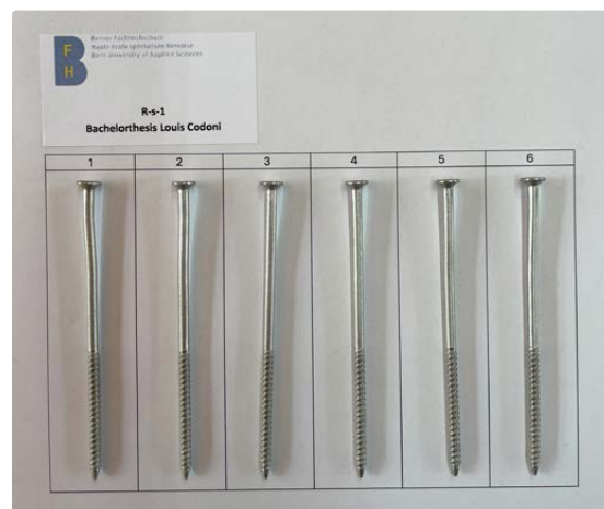
Nagelschrauben nach Erdbebenbelastung
