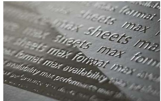
Abbildung 1: Spotlackierung zur Erzielung von gezielten Glanz- und Struktureffekten auf Verpackungsdruckbögen.
