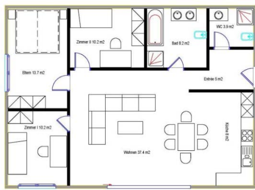
Abb. 8 > Modellwohnung im Mehrfamilienhaus Neubau
